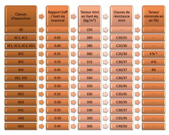
Il est possible de déroger à la teneur minimale en air pour les bétons conformes aux spécifications de la classe XD3 (sauf éléments très exposés aux sels de déverglaçage)
